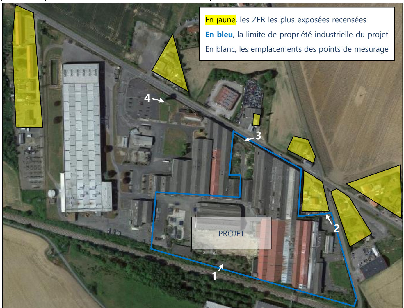
Figure 3 : Emplacement des points de mesurage et des ZER
